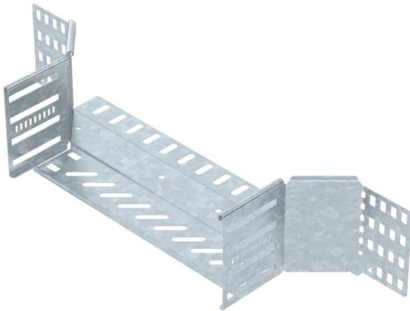
Anbau-Abzweigstück zum Erstellen einer horizontalen Abzweigung oder Kreuzung, Formteil für rast- und schraubbare Kabelrinnen Seitenhöhe 110 mm. Schraubenlose Montage mit Doppelklemmen oder Schraubverbindung mit Flachrundschrauben FRS und Kombimuttern M6. Einsetzbar im Innen- und Außenbereich. Befestigungsmaterial muss separat bestellt werden.
