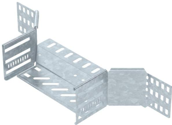
Anbau-Abzweigstück zum Erstellen einer horizontalen Abzweigung oder Kreuzung, Formteil für rast- und schraubbare Kabelrinnen Seitenhöhe 85 mm. Schraubenlose Montage mit Doppelklemmen oder Schraubverbindung mit Flachrundschrauben FRS und Kombimuttern M6. Einsetzbar im Innen- und Außenbereich. Befestigungsmaterial muss separat bestellt werden.
