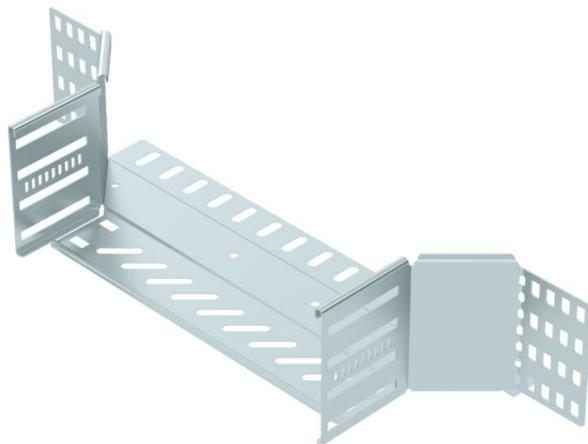
Anbau-Abzweigstück zum Erstellen einer horizontalen Abzweigung oder Kreuzung, Formteil für rast- und schraubbare Kabelrinnen Seitenhöhe 110 mm. Schraubenlose Montage mit Doppelklemmen oder Schraubverbindung mit Flachrundschrauben FRS und Kombimuttern M6. Einsetzbar im Innenbereich. Befestigungsmaterial muss separat bestellt werden.
