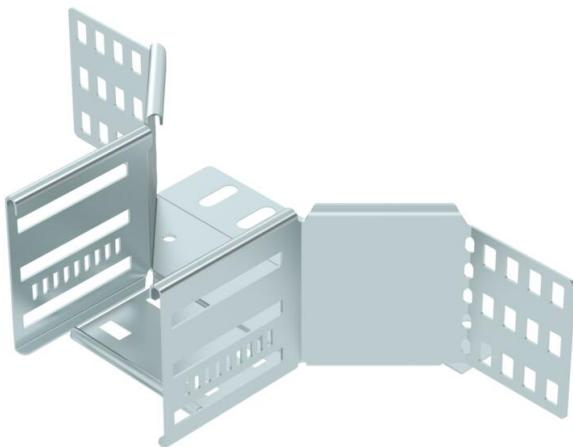
Anbau-Abzweigstück zum Erstellen einer horizontalen Abzweigung oder Kreuzung, Formteil für rast- und schraubbare Kabelrinnen Seitenhöhe 85 mm. Schraubenlose Montage mit Doppelklemmen oder Schraubverbindung mit Flachrundschrauben FRS und Kombimuttern M6. Einsetzbar im Innenbereich. Befestigungsmaterial muss separat bestellt werden.
