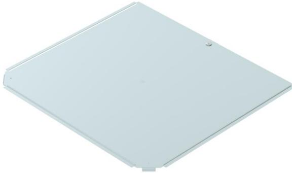
Deckel für Formteil T-Stück für rastbare und schraubbare Kabelrinnen im Innenbereich, zum Schutz der Kabel vor Beschädigungen und Schmutz. Befestigung mit vormontiertem Drehriegel und Befestigung durch Auflage des Streckendeckels. Passend für alle Seitenhöhen.
