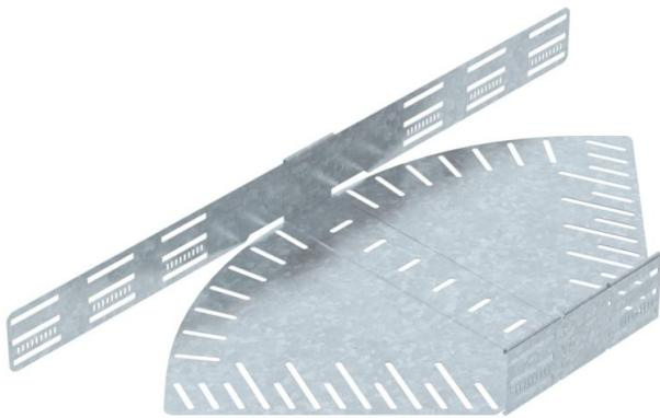
Winkelverstellbarer Bogen zum Erstellen einer horizontalen Abzweigung, Formteil für rast- und schraubbare Kabelrinnen Seitenhöhe 85 mm. Einstellbarer Winkel 0 - 90°. Schraubenlose Montage mit Doppelklemmen oder Schraubverbindung mit Flachrundschrauben FRS und Kombimuttern M6. Einsetzbar im Innen- und Außenbereich. Befestigungsmaterial muss separat bestellt werden.
