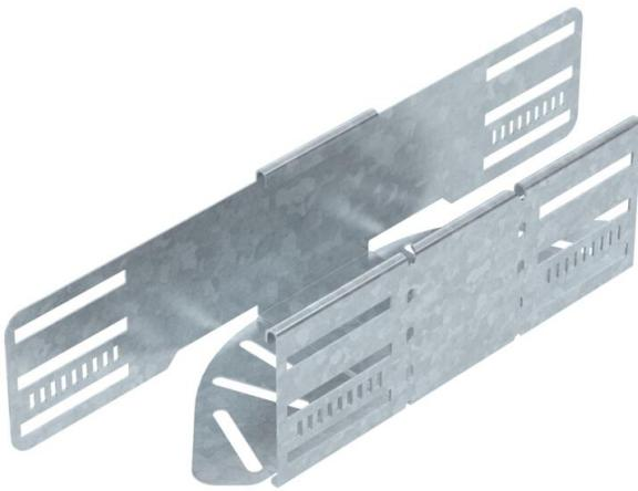
Winkelverstellbarer Bogen zum Erstellen einer horizontalen Abzweigung, Formteil für rast- und schraubbare Kabelrinnen Seitenhöhe 85 mm. Einstellbarer Winkel 0 - 90°. Schraubenlose Montage mit Doppelklemmen oder Schraubverbindung mit Flachrundschrauben FRS und Kombimuttern M6. Einsetzbar im Innen- und Außenbereich. Befestigungsmaterial muss separat bestellt werden.
