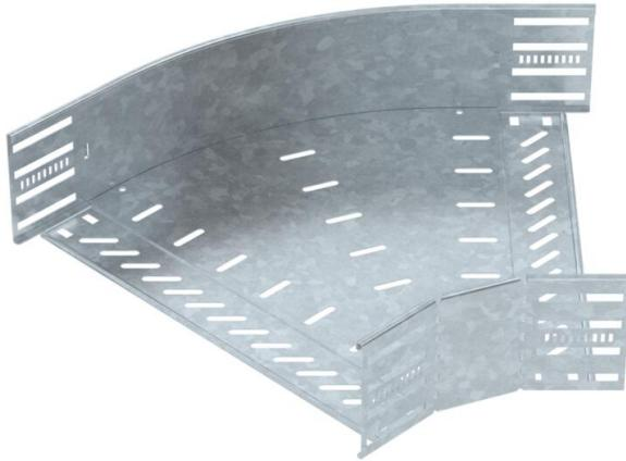
45°-Bogen zum Erstellen einer horizontalen Abzweigung, Formteil für rast- und schraubbare Kabelrinnen Seitenhöhe 110 mm. Schraubenlose Montage mit Doppelklemmen oder Schraubverbindung mit Flachrundschrauben FRS und Kombimuttern M6. Einsetzbar im Innen- und Außenbereich. Befestigungsmaterial muss separat bestellt werden.
