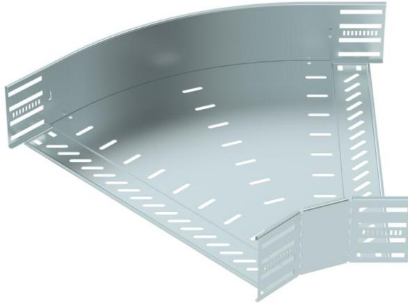
45°-Bogen zum Erstellen einer horizontalen Abzweigung, Formteil für rast- und schraubbare Kabelrinnen Seitenhöhe 110 mm. Schraubenlose Montage mit Doppelklemmen oder Schraubverbindung mit Flachrundschrauben FRS und Kombimuttern M6. Einsetzbar im Innenbereich. Befestigungsmaterial muss separat bestellt werden.
