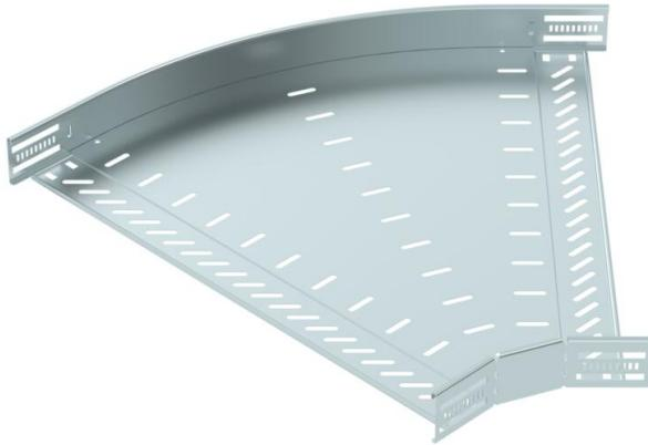
45°-Bogen zum Erstellen einer horizontalen Abzweigung, Formteil für rast- und schraubbare Kabelrinnen Seitenhöhe 60 mm. Schraubenlose Montage mit Doppelklemmen oder Schraubverbindung mit Flachrundschrauben FRS und Kombimuttern M6. Einsetzbar im Innenbereich. Befestigungsmaterial muss separat bestellt werden.
