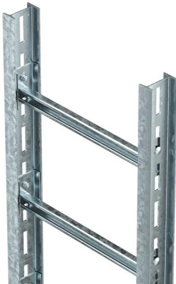
Industrie-Steigeleiter-System für den elektrischen Funktionserhalt nach DIN 4102 Teil 12. Zugelassene Schellen Typ BS-U1-M-... FT. Lieferung erfolgt unmontiert. Sprossenabstand 300 mm. Sprossen Typ CK 40/... und Schrauben Typ FRS 10 x 25 FT werden zu Holmprofilen unmontiert geliefert.
