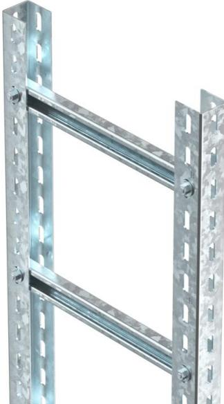
Schweres Steigeleiter-System für den elektrischen Funktionserhalt nach DIN 4102 Teil 12. Zugelassene Schellen Typ BS-U1-M-... FT. Lieferung erfolgt unmontiert. Sprossen Typ C 40/... und Schrauben Typ FRS 8x35 werden zu Holmprofilen unmontiert geliefert. Sprossenabstand: 300 mm
