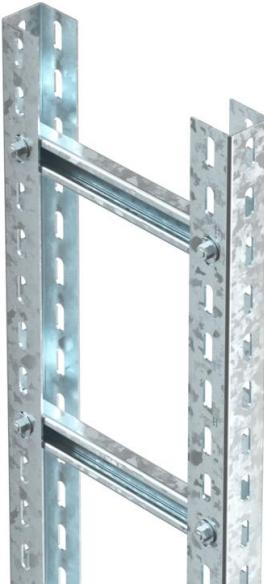
Schweres Steigeleiter-System für den elektrischen Funktionserhalt nach DIN 4102 Teil 12. Zugelassene Schellen Typ BS-U1-M-... FT. Lieferung erfolgt unmontiert. Sprossen Typ C 40/... und Schrauben Typ FRS 8x35 werden zu Holmprofilen unmontiert geliefert. Sprossenabstand: 300 mm
