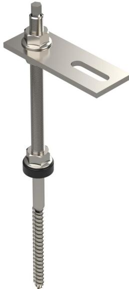
Stockschraubenset zum Montieren von Photovoltaik-Modulen auf Schrägdächern in Kombination mit Trägerprofil TP 45. Geeignet zur Befestigung in der Holzunterkonstruktion von Welldächern aus Kunststoff, Blech oder Faserzement. Set bestehend aus Stockschraube mit vormontierter EPDM-Dichtung, Adapterplatte für Trägerprofil und zusätzlichen Muttern für optionalen Höhenausgleich. Befestigung des Trägerprofils mit Schraube mit Hammermutter Typ SKS HM (muss separat bestellt werden).
