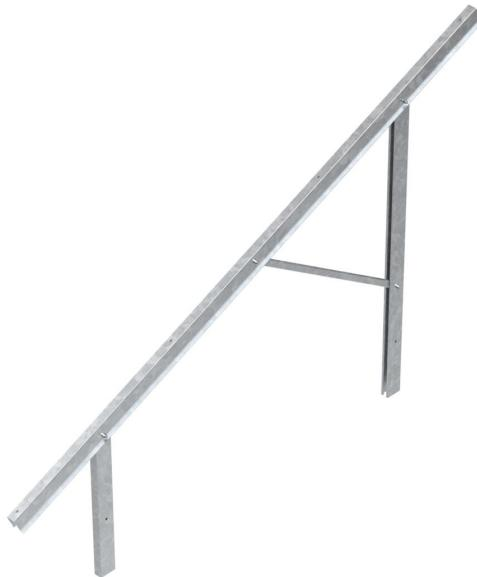
Vormontierter Träger in kleiner, mittlerer oder großer Ausführung zum Montieren von Photovoltaik-Freiflächensystemen in Kombination mit Trägerprofilen und End-/Zwischenklemmen. Montage mit Rammprofilen im Erdreich oder mit Standfüßen auf Betonfundamenten.
