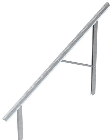
Vormontierter Träger in kleiner, mittlerer oder großer Ausführung zum Montieren von Photovoltaik-Freiflächensystemen in Kombination mit Trägerprofilen und End-/Zwischenklemmen. Montage mit Rammprofilen im Erdreich oder mit Standfüßen auf Betonfundamenten.
