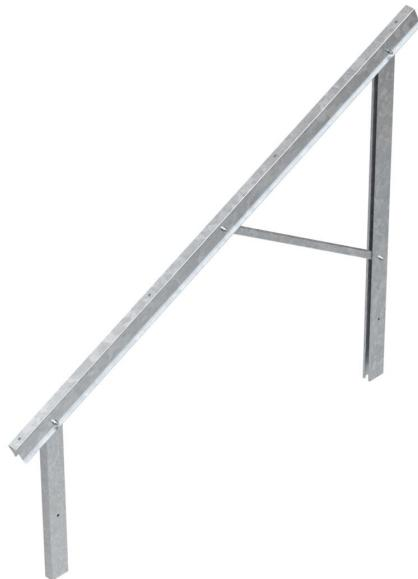
Vormontierter Träger in kleiner, mittlerer oder großer Ausführung zum Montieren von Photovoltaik-Freiflächensystemen in Kombination mit Trägerprofilen und End-/Zwischenklemmen. Montage mit Rammprofilen im Erdreich oder mit Standfüßen auf Betonfundamenten.
