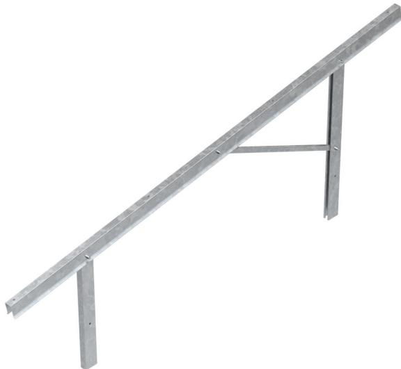
Vormontierter Träger in kleiner, mittlerer oder großer Ausführung zum Montieren von Photovoltaik-Freiflächensystemen in Kombination mit Trägerprofilen und End-/Zwischenklemmen. Montage mit Rammprofilen im Erdreich oder mit Standfüßen auf Betonfundamenten.
