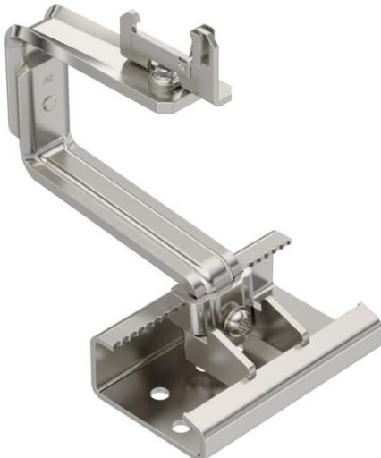
Dachhaken zum Montieren von Photovoltaik-Modulen auf Schrägdächern in Kombination mit Trägerprofil TP 45. Geeignet für Ziegeldächer. Rastbare Befestigung an Trägerprofil. Montage an Dachsparren mit Tellerkopfschrauben TKS. Dachhaken ist horizontal und vertikal über Verschraubungen stufenlos einstellbar, passender Schlüssel Torx 40. Höheneinstellung im Bereich der Dachlatte von 40-54 mm, seitliche Verstellmöglichkeit bis zu 76 mm, Höhenverstellung des Trägerprofils bis zu 18 mm.
