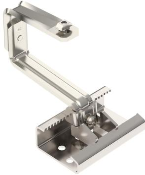
Dachhaken zum Montieren von Photovoltaik-Modulen auf Schrägdächern in Kombination mit Trägerprofil TP 45. Geeignet für Ziegeldächer. Schraubbare Befestigung an Trägerprofil. Montage an Dachsparren mit Tellerkopschrauben TKS. Dachhaken ist horizontal und vertikal über Verschraubungen stufenlos einstellbar, passender Schlüssel Torx 40. Höheneinstellung im Bereich der Dachlatte von 40-54 mm, seitliche Verstellmöglichkeit bis zu 76 mm, Höhenverstellung des Trägerprofils bis zu 18 mm.
