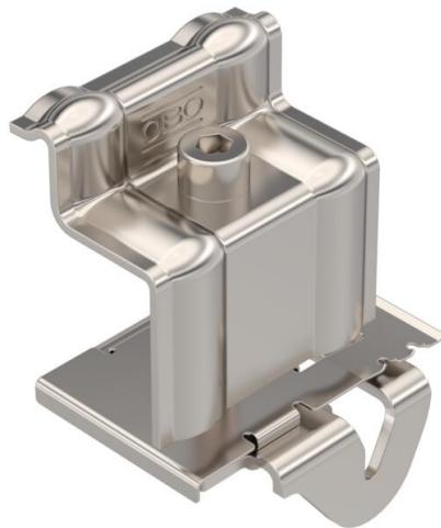
Endklemme zum Befestigen von Photovoltaik-Modulen auf Trägerprofilen von Freiflächensystemen. Rastbare Vorbefestigung der Modulrahmen an Trägerprofil. Geeignet für Schlitzweite 10 mm. Schraubbare Befestigung des PV-Moduls mit Innensechskant-Schlüssel Größe 6.
