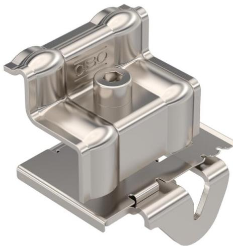
Endklemme zum Befestigen von Photovoltaik-Modulen auf Trägerprofilen von Freiflächensystemen. Rastbare Vorbefestigung der Modulrahmen an Trägerprofil. Geeignet für Schlitzweite 10 mm. Schraubbare Befestigung des PV-Moduls mit Innensechskant-Schlüssel Größe 6.
