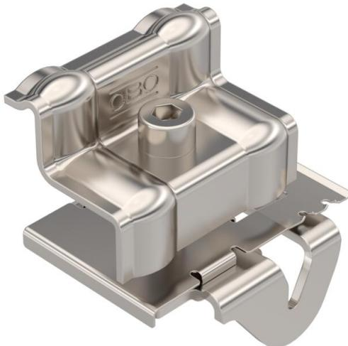
Endklemme zum Befestigen von Photovoltaik-Modulen auf Trägerprofilen von Freiflächensystemen. Rastbare Vorbefestigung der Modulrahmen an Trägerprofil. Geeignet für Schlitzweite 10 mm. Schraubbare Befestigung des PV-Moduls mit Innensechskant-Schlüssel Größe 6.
