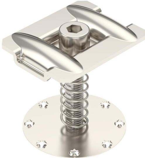
Zwischenklemme mit Feder zum Befestigen von Photovoltaik-Modulen auf Trägerprofilen. Geeignet für Schlitzweite 10 mm. Schraubbare Befestigung des PV-Moduls mit Innensechskant-Schlüssel Größe 6.
