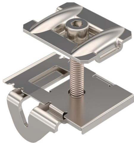
Zwischenklemme zum Befestigen von Photovoltaik-Modulen auf Trägerprofilen von Freiflächensystemen. Rastbare Vorbefestigung der Modulrahmen an Trägerprofil. Geeignet für Schlitzweite 10 mm. Schraubbare Befestigung des PV-Moduls mit Innensechskant-Schlüssel Größe 6.
