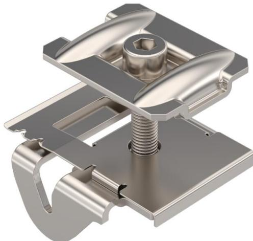
Zwischenklemme zum Befestigen von Photovoltaik-Modulen auf Trägerprofilen von Freiflächensystemen. Rastbare Vorbefestigung der Modulrahmen an Trägerprofil. Geeignet für Schlitzweite 10 mm. Schraubbare Befestigung des PV-Moduls mit Innensechskant-Schlüssel Größe 6.
