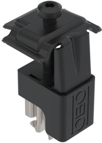
Universalklemme zum Montieren von Photovoltaik-Modulen auf Flach- und Schrägdächern, geeignet als Klemme zwischen 2 Modulen oder als Endklemme. Rastbare Vorbefestigung an Trägerprofil TP 45 sowie an Stützen STK und STL. Geeignet für Schlitzweite 10 mm. Nach Einrasten um 90° drehbar. Schraubbare Befestigung des PV-Moduls mit Schlüssel Torx 30. Ausführung schwarz.
