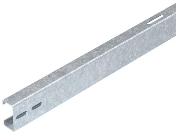
Trägerprofil zum Montieren von Photovoltaik-Modulen auf Freiflächen systemen. Montage des Trägerprofils auf vormontierten Trägern mit Kreuzverbinder KV FT. Montage der PV-Module am Trägerprofil mit End- und/oder Zwischenklemmen. Verbindung mehrerer Trägerprofile mit Längsverbinder LV FT oder Kreuzverbinder KV FT, schraubbar.
