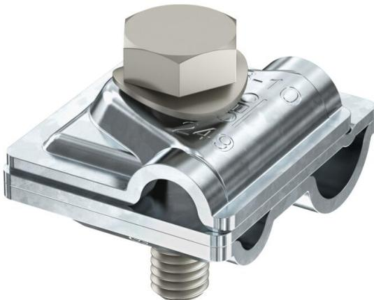
Schnellverbinder zum Erstellen von T-, Kreuz- und Parallel-Verbindungen. Montage mit Schraube M10 x 40 aus rostfreiem Edelstahl. Passend für Bewehrungsstäbe ø 6-16 mm und Rundleiter ø 8-10 mm. Entspricht den Anforderungen nach VDE 0185-305 (IEC 62305).
