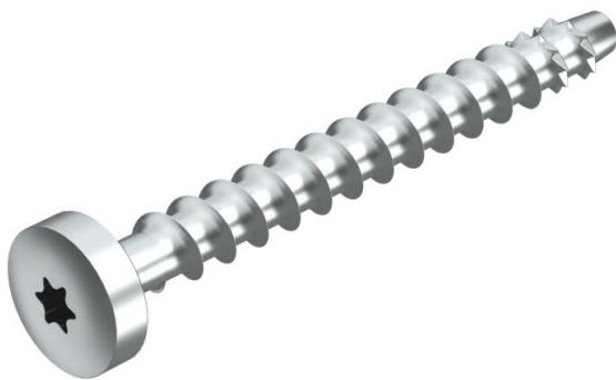
Schraubanker zur direkten Montage ohne Dübel in gerissenem und ungerissenem Beton sowie Mauerwerk. Mit Rundkopf für universelle Befestigungen. Tork-Antrieb T30
