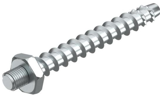
Schraubanker zur direkten Montage ohne Dübel in gerissenem und ungerissenem Beton sowie Mauerwerk. Anschlussgewinde M6 für die Befestigung von Schellen mit Gewindefuss.
