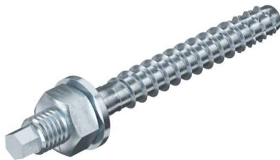
Schraubanker zur direkten Montage ohne Dübel in gerissenem und ungerissenem Beton sowie Mauerwerk. Mit Anschlussgewinde und Unterlegscheibe zur Aufnahme großer Lasten. Geeignet für die Befestigung von Hängestiegen und Wandauslegern in Durchsteckmontage.
