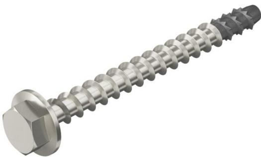
Edelstahl-Schraubanker zur direkten Montage ohne Dübel in gerissenem und ungerissenem Beton sowie Mauerwerk. Mit Sechskantanztrieb und angepresster Scheibe zur Aufnahme großer Lasten. Geeignet für die Befestigung von Hängesthlen und Wandauslegern in Feuchträumen und im Außenbereich. Gemäß EAD geprüftes, CE-gekennzeichnetes Bauprodukt mit Europäisch Technischer Bewertung (ETA) und Anwendbarkeitsnachweis. Tragfähigkeiten unter Brandbelastung bis zur Feuerwiderstandsklasse R120 nachgewiesen.
