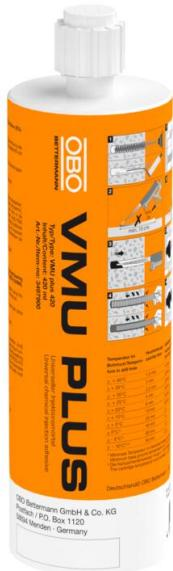
Styrenfreier Vinylester-Verbundmörtel zur spreizfreien Verankerung hoher Lasten mit Gewinde-Ankerstangen. Koaxialkartusche inklusive 1 Mischrohr, zu verarbeiten mit Auspresspistole Typ VM-P 380 Profi.
