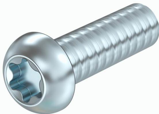
Flachkopfschraube mit TX 30, nach ISO 7380-1, geeignet zur Befestigung von Kabeltrassen auf Auslegern sowie zur Montage von Trennstegen. Durch die abgerundete Kopfform wird ein optimaler Schutz des Kabels realisiert. Der Torx Antrieb bietet eine optimale Kraftübertragung bei der Schraubbewegung.
