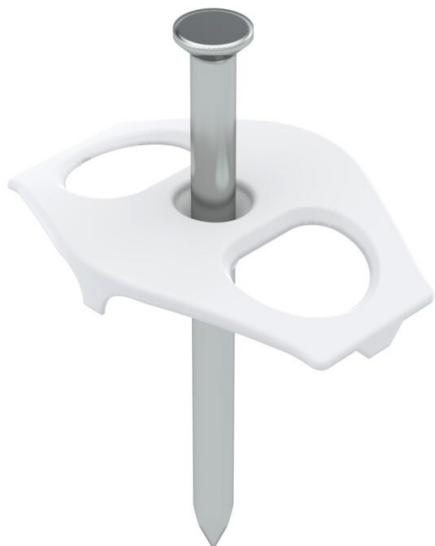
Mit vormontiertem, verzinkten Stahlnagel Ø 3 mm oder 3,5 mm zur Fixierung von Leitungen in Mauerschlitzten und auf Mauerwerk für 1 bzw. 2 Leitungen NYM 3 x 1,5/2,5 mm<sup>2</sup> oder 1 bzw. 2 Leitungen NYM 5 x 1,5/2,5 mm<sup>2</sup>.
