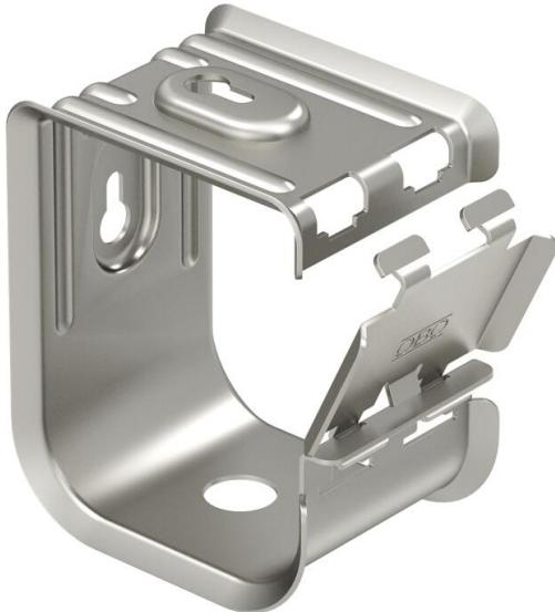
Sammelhalter aus Metall für hohe mechanische Standfestigkeit, auch im Brandfall. Zur sicheren Montage oberhalb von Brandschutzdecken geeignet. Auch als kabelspezifische Variante für den elektrischen Funktionserhalt nach DIN 4102 Teil 12 zugelassen. Für Wand- und Deckenmontage. Verschluss ohne Werkzeug zu öffnen. Detaillierte Informationen der zugelassenen Verlegevarianten sind den entsprechenden Prüfdokumenten zu entnehmen.
