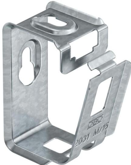
Sammelhalter aus Metall für hohe mechanische Standfestigkeit, auch im Brandfall. Zur sicheren Montage oberhalb von Brandschutzecken geeignet. Auch als kabelspezifische Variante für den elektrischen Funktionserhalt nach DIN 4102 Teil 12 zugelassen. Für Wand- und Deckenmontage. Verschluss ohne Werkzeuge zu öffnen. Detaillierte Informationen der zugelassenen Verlegevarianten sind den entsprechenden Prüfdokumenten zu entnehmen.
