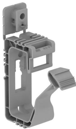
Sammelhalterung mit angespritztem Befestigungselement, zum Montieren von bis zu 20 Leitungen NYM 3 x 1,5 mm<sup>2</sup> an Wand oder Decke. Befestigung mit Schlagdübel oder Steckdübel. Befestigungsloch Ø 6 mm. Empfohlener Befestigungsabstand bei voller Belegung 250-400 cm, abhängig von den jeweilig gültigen nationalen Vorgaben/Normen. Flammwidrig nach DIN VDE 0471/DIN IEC 695 Teil 2-1, Prüftemperatur 960°C.
