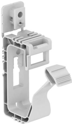
Sammelhalterung mit angespritztem Befestigungselement, zum Montieren von bis zu 20 Leitungen NYM 3 x 1,5 mm<sup>2</sup> an Wand oder Decke. Befestigung mit Schlagdübel oder Steckdübel. Auch geeignet zum Befestigen mit gas- und akku-betriebenen Setzgeräten der Marken Bosch, Fischer und Spit (Nasendurchmesser innen Ø 7 mm). Befestigungsloch Ø 6 mm. Empfohlener Befestigungsabstand bei voller Belegung 250-400 mm, abhängig von den jeweilig gültigen nationalen Vorgaben/Normen.
