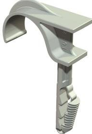
Die Steckschellen dienen zur Verlegung von Leitungen und Rohren an Wand und Decke und der Verlegung von flexiblen Rohren auf Beton und im Estrich. Die Einfachsteckschellen ersetzen Nagelclips in Beton und Gasbeton. Der Vorteil der Steckschellen liegt darin, dass sie nur in das Bohrloch gesteckt werden müssen. Es entfällt die Verwendung von Dübeln und Schrauben.
