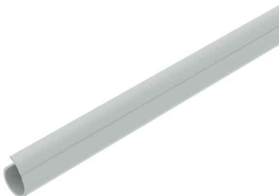
Offenes Rohr Quick-Pipe® aus Kunststoff zum Aufputz-Verlegen von Kabeln und Leitungen im Innen- und geschützten Außenbereich. Montage an Wand und Decke mit Quick-Schelle, proQuick-Schelle und Multi-Quick-Schelle. Werkzeugloses Verschließen und Öffnen durch Drehen in der Schelle. Einsetzbar im Temperaturbereich von - 25° bis + 60° C.
