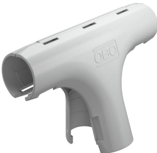
Formteil für Elektroinstallationsrohre aus Kunststoff zum Erstellen von T-Abzweigen. Geeignet für Rohr Quick-Pipe® oder Wellrohre. Werkzeugloses Verschließen und Öffnen. Einsetzbar im Temperaturbereich von - 25° bis + 60° C.
