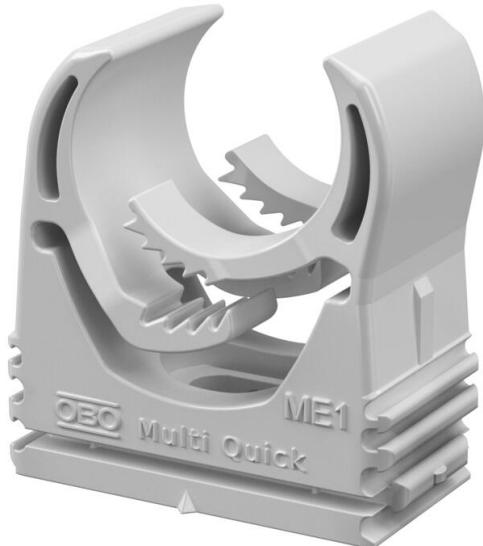
Aufputzschelle zur Aufnahme von metrischen Rohren sowie Elektroinstallationsrohr Quick-Pipe. Flexibler Spannbereich von mehreren Millimetern. Universelle Befestigungsmöglichkeiten an Wand und Decke im Innen- und Außenbereich. Werkzeuglose Rohrmontage. Aneinander reihbar auch mit OBO Quick- oder pro-Quick-Schelle.
