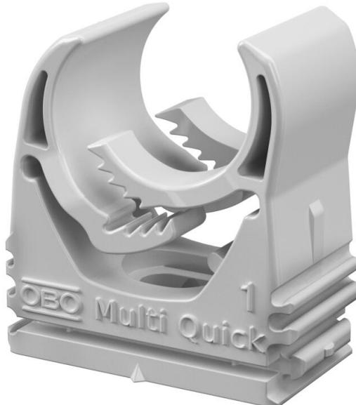
Aufputzschelle zur Aufnahme von metrischen und PG-Rohren sowie Elektroinstallationsrohr Quick-Pipe. Flexible Spannbereich von mehreren Millimetern. Universelle Befestigungsmöglichkeiten an Wand und Decke und einsetzbar in Profilschiene im Innen- und geschützten Außenbereich. Werkzeuglose Rohrmontage. Aneinander reihbar auch mit OBO Quick- oder proQuick-Schelle.
