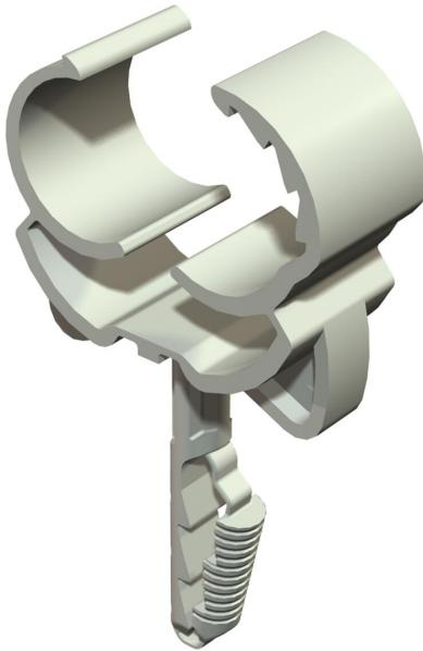
Mit angespritztem Steckdübel zur Schnellmontage in Betonwänden und Mauerwerk. Dübel bis zum Aufliegen der Schellenunterkante ins Bohrloch einstecken, beim Eindrücken des Rohres schließt und rastet die Schelle selbsttätig ums Rohr.
