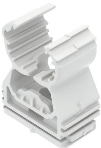
Hochbelastbare Schelle zur Aufnahme von Elektro- und Sanitärrohren aus Kunststoff und Metall sowie Elektroinstallationsrohr Quick-Pipe. Universelle Befestigungsmöglichkeiten an Wand, Decke und Stahlkonstruktionen im Innen- und Außenbereich. Flexibler Spannbereich von mehreren Millimetern. Werkzeuglose Rohrmontage. Aneinander reihbar bis Ø 32 mm, auch mit OBO Quick- oder Multi-Quick-Schelle. Für variable Abstände und Schellenanzahl montierbar auf Profilschiene.
