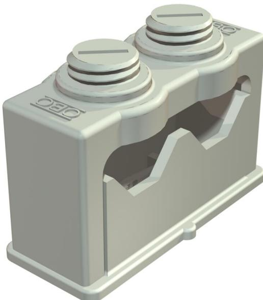
Solide Kabelbefestigung durch Klemmschrauben, mit Klebefuß, Langloch und zum Aufschrauben auf Gewinde M6. Zum Kleben der Polystyrol-Schellen auf Mauerwerk und Beton Impu-Fix-Stegleitungs-Schnellkleber Typ 509 verwenden.
