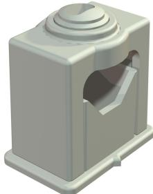
Solide Kabelbefestigung durch Klemmschrauben, mit Klebefuß, Langloch und zum Aufschrauben auf Gewinde M6. Zum Kleben der Polystyrol-Schellen auf Mauerwerk und Beton Impu-Fix-Stegleitungs-Schnellkleber Typ 509 verwenden.
