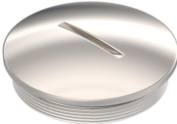
Verschlusschraube aus Metall mit integriertem Dichtring. Zum Verschließen von nicht genutzten Gewindeöffnungen z. B. in Gehäusen oder Abzweigdosen. Mit metrischem Gewinde nach DIN EN 60423 oder ISO 68. Schutzart IP 68 (5 bar/1 h).
